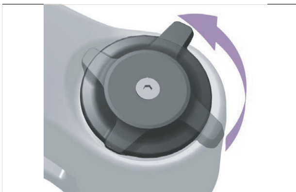
Obr. 239: Měkčí nastavení nastavovacím šroubem komprese
