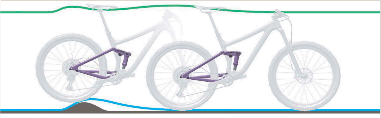
Obr. 270: Příliš tvrdé tlumení tlumiče zadního odpružení u nerovnosti
