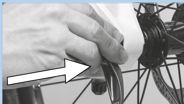
Obr. 85: Zasunutí rychloupínáku ve směru šipky
