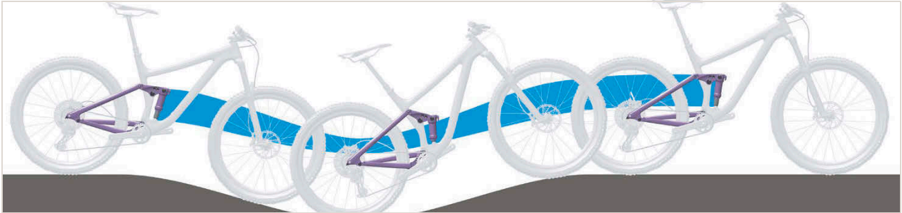
Obr. 276: Příliš měkké odpružení tlumiče zadního odpružení v horách
