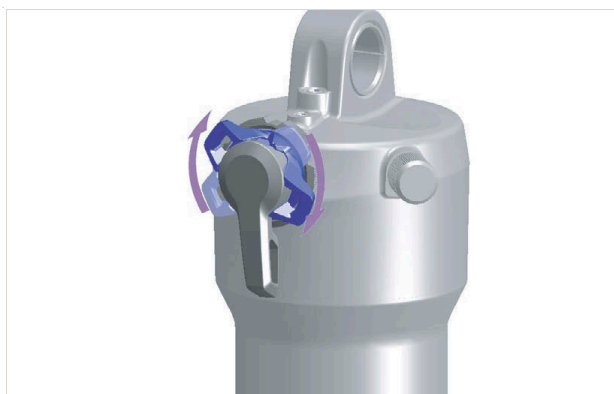
Obr. 175: Tvrdší nastavení nastavovacím šroubem komprese
