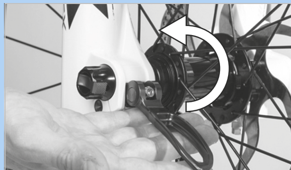
Obr. 81: Stlačte páku rychloupínáku ve směru šipky
