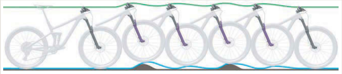
Obr. 246: Příliš rychlé roztahování odpružené vidlice
