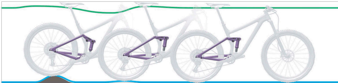
Obr. 256: Příliš rychlé roztahování tlumiče zadního odpružení
