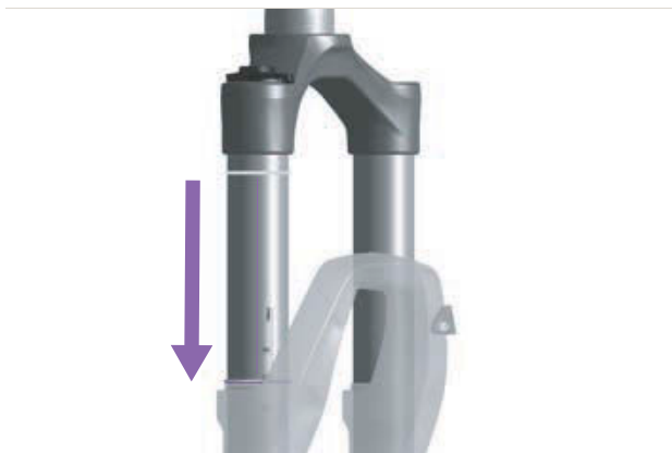
Obr. 132: Posunutí O-kroužku odpružené vidlice
