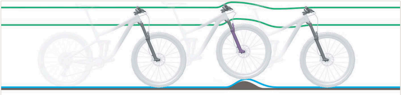
Obr. 238: Příliš tvrdé tlumení odpružené vidlice u nerovnosti
