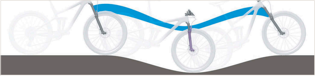
Obr. 236: Příliš měkké odpružení odpružené vidlice v horách
