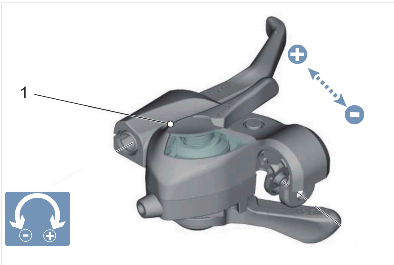
Obr. 125: Poloha seřizovacího šroubu (1)
