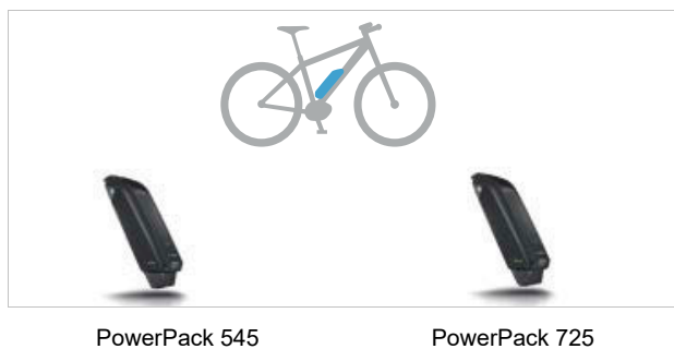
Obr. 50: Přehled - akumulátoru v rámu
