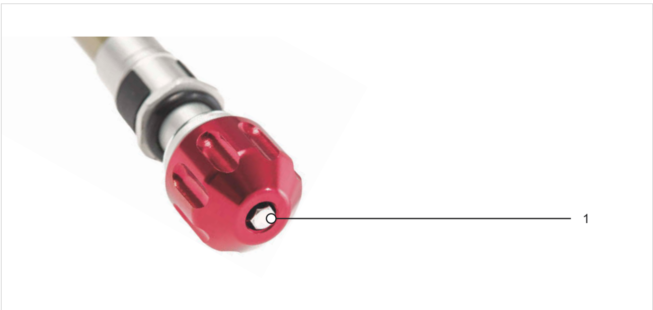
Obr. 243: Příklad nastavovacího šroubu odskoku (vidlice) SR SUNTOUR (1)
