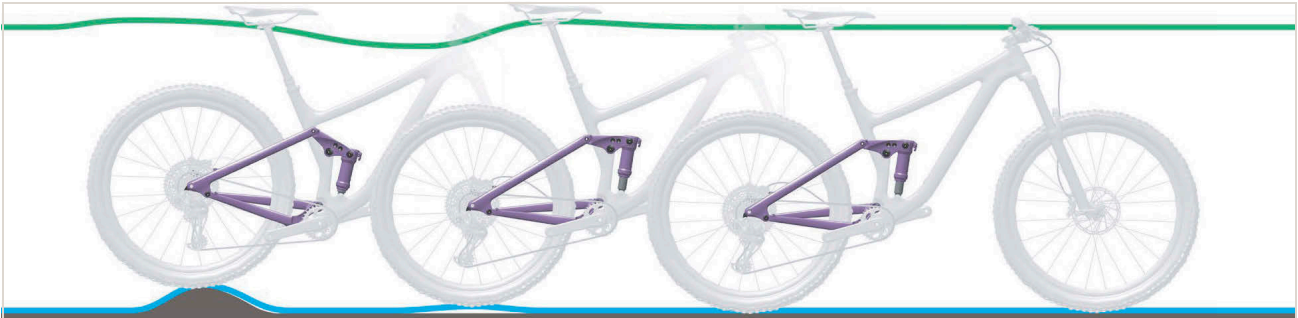
Obr. 264: Příliš rychlé roztahování tlumiče zadního odpružení
