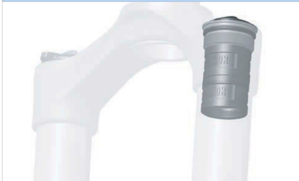
Obr. 137: Dva Bottomless Tokens v odpružení DebonAir
