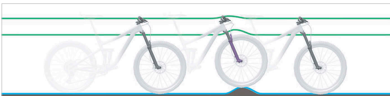
Obr. 130: Optimální chování vidlice při jízdě u nerovnosti
