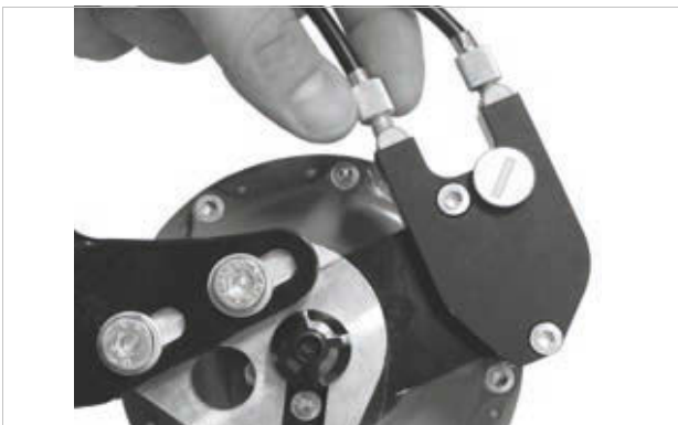
Obr. 225: Náboje ROHLOFF s externím ovládním řazení mají seřizovače napnutí na lanovodu, který je umístěn na levé straně
