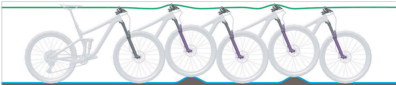
Obr. 15: Optimální chování vidlice při jízdě
