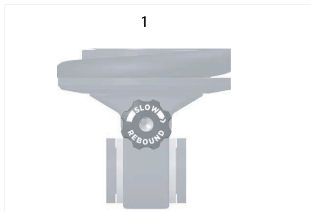
Obr. 155: Nastavovací šroub odskoku Float DHX (1)
