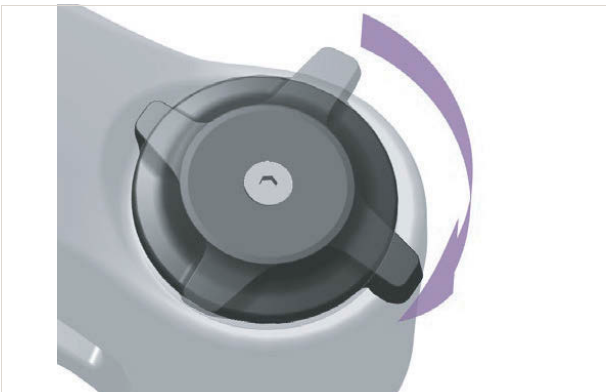
Obr. 237: Tvrďší nastavení nastavovacím šroubem komprese
