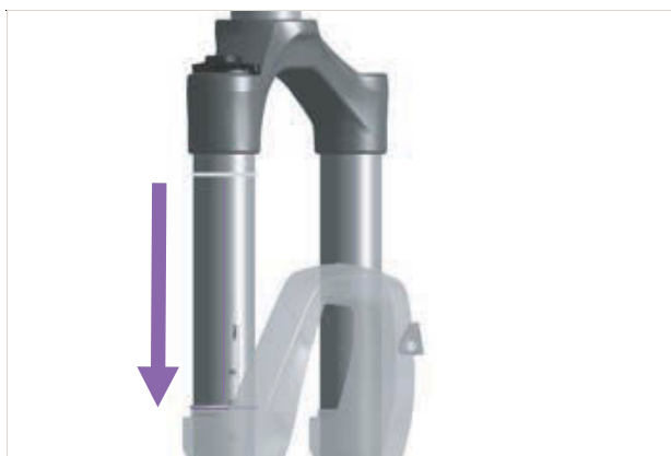
Obr. 135: Posunutí O-kroužku na odpružené vidlici
